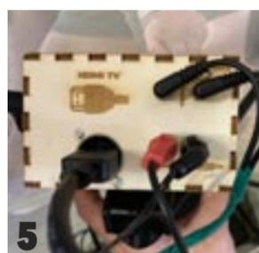
5 Connecter tous les câbles au SYSTEME VIDEO = CAPTEURS HDMI ENCEINTES ALIMENTATION sur le côté
