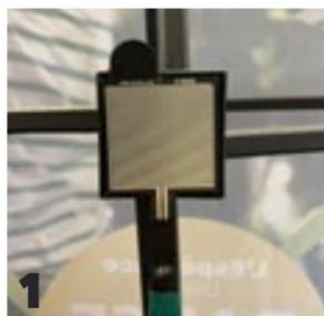
1 Clipser les 2 capteurs sur le repère vert maintenus par un aimant
